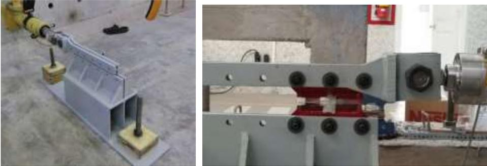
**Figura 4** Base y canal sobre el que pasa disipador SLB, a la derecha actuador que proporciona las cargas laterales, en forma monotónica.
