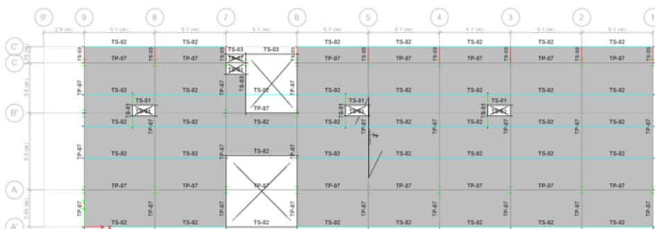
Figura 8 Vista en planta de las vigas de acero de la losa de la planta baja, de UVC de Manta. Aguiar et al. (2016).
