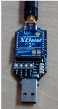
Fig. 12. Módulo XBee PRO Series 2 con su gateway USB
