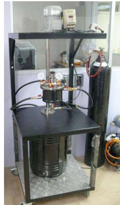
Figura 13. Molino de atrición para aleaciones mecánicas.
