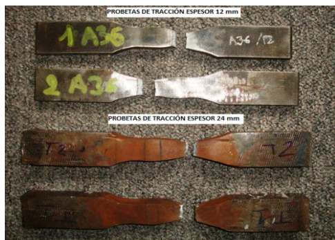
Figura 2. Probetas ensayadas a tracción acero ASTM A36
