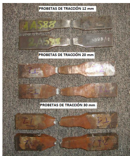
Figura 3. Probetas ensayadas a tracción acero ASTM A588
