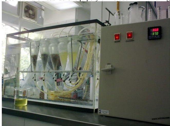
Figura 2. Equipo para evaluar la bioaccesibilidad según el método PBET en el Laboratorio de Geoquímica Ambiental, del Instituto de Geología (UNAM). En ambas imágenes es posible apreciar las mangueras para el flujo de argón que es usado como sistema de agitación
