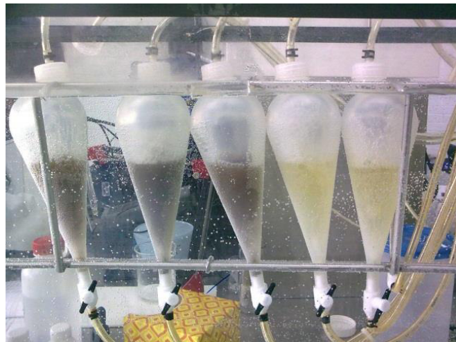
Figura 2. Equipo para evaluar la bioaccesibilidad según el método PBET en el Laboratorio de Geoquímica Ambiental, del Instituto de Geología (UNAM). En ambas imágenes es posible apreciar las mangueras para el flujo de argón que es usado como sistema de agitación
