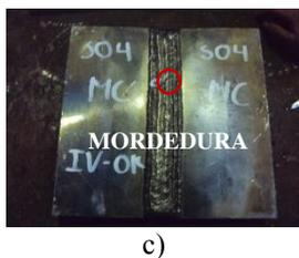
Figura 3. INSPECCIÓN VISUAL DE LOS CUPONES DE SOLDADURA
