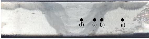
Figura 10. UBICACIÓN DE LAS METALOGRAFÍAS
