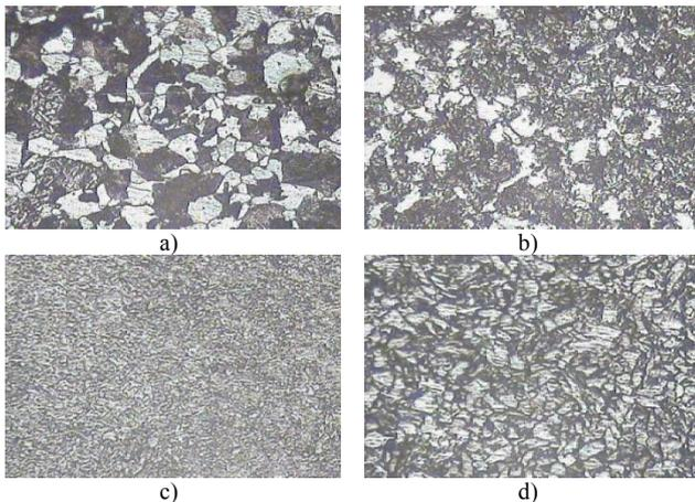
Figura 12. METALOGRAFÍAS DEL PROCEDIMIENTO S02. a) MATRIZ FERRÍTICA CON ISLAS DE PERLITA. b) ZONA DE TRANSICIÓN. c) MATRIZ PERLITICA FERRITICA DE GRANO FINO. d) MATRIZ FERRITICA PERLITICA
