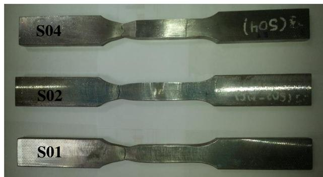
Figura 5. PROBETAS ENSAYADAS A TRACCIÓN
