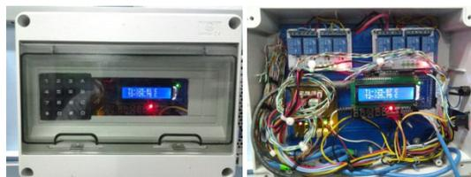
**Fig. 1 Vista interior y exterior del módulo de control principal**
