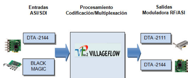
Figura 2 Diagrama de bloques entrada, proceso y salida que conforman la plataforma VillageFlow.
