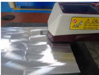
Fig. 4. Medición de la rugosidad superficial
