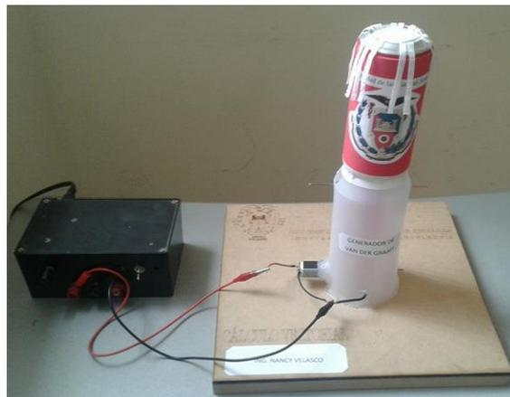
**Figura 6.** Maqueta finalizada del generador de Van Der Graaff. Fuente Propia.
