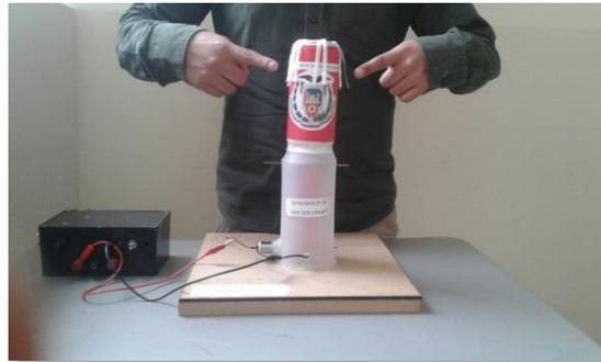
Figura 7. . Maqueta del generador de Van Der Graaff apagado. Fuente Propia
