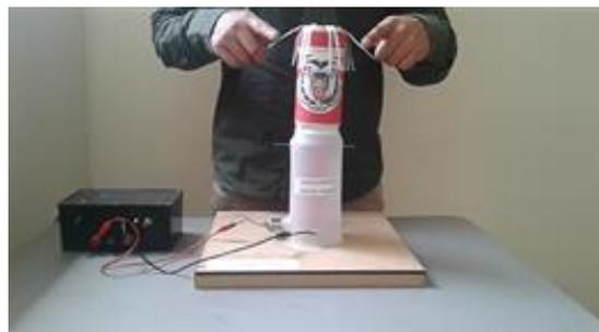
Figura 8. Maqueta del generador de Van Der Graaff encendido. Fuente Propia
