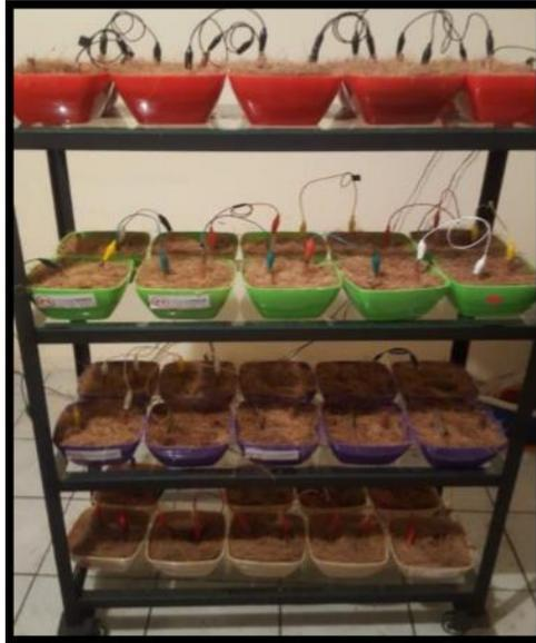
**Figura 1.** Celda galvánica compuesta por 40 semiceldas a base de fibra de coco. Fuente Propia
