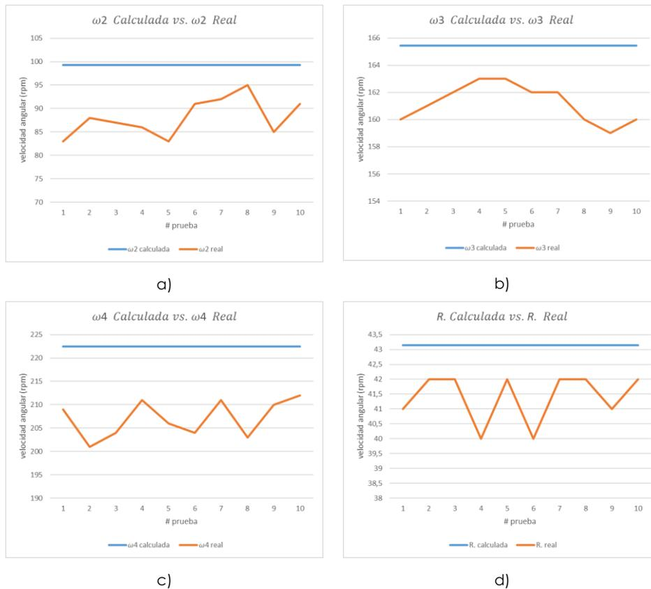
**Figura 8.** Velocidades calculadas vs. reales, a) 2da marcha, b) 3ra marcha, c) 4ta marcha d) reversa. Fuente Propia
