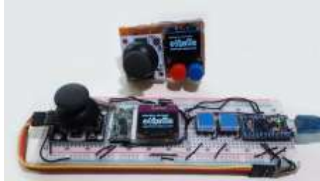
Figura 8. Conexión del módulo joystick con Arduino
