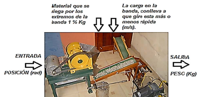
Fig. 3. Foto de la trituradora en la que se indican las señales de entrada, salida y las perturbaciones.
