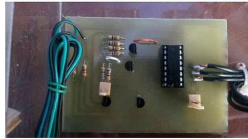
Fig 16. Placa del circuito multiplexor.
