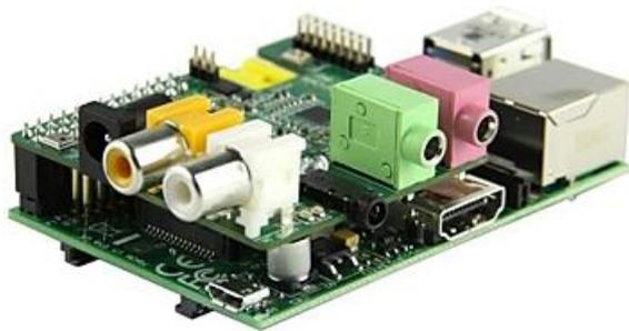
Fig 6. Raspberry con tarjeta de audio Wolfson.
