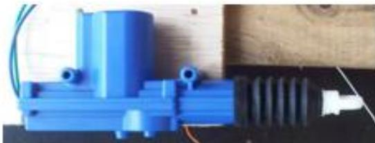
Figura 10. Actuator lineal de 20 [mm]
