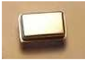
Fig. 1. Oscilador controlado por Voltaje
