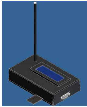
Fig. 13. Inserción de MMC/SD en la Ranura
