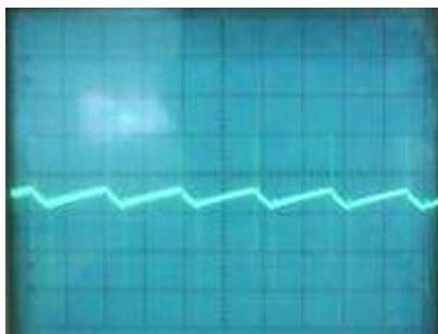
Fig. 26. Corriente de armadura al 25% de voltaje a 1kHz, giro derecho
