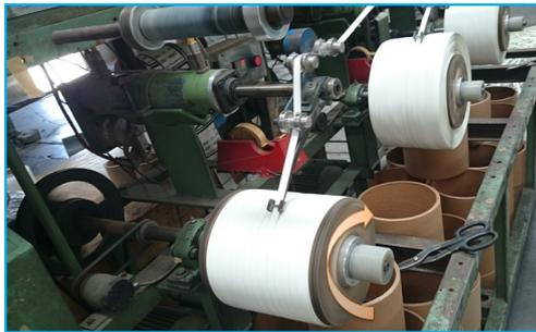
Figura 1. Rotación de eje a velocidad variable para enrollamiento de fleje tipo PP de 12 mm
