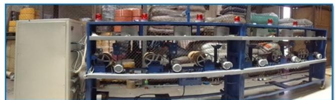
Figura 9. Canalización externa de actuadores y sensores
