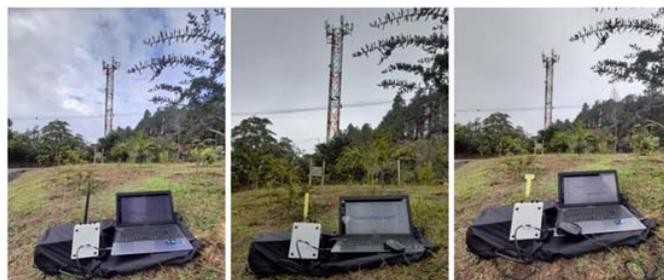
Fig. 7. Medidas de intensidad de la señal izquierda antena VERT900, centro antena monopolo, derecha antena monopolo con anillo dividido
