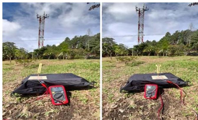
Fig. 10. Captación de energía RF mediante rectennas. Izquierda rectenna monopolo. Derecha antena monopolo con anillo dividido
