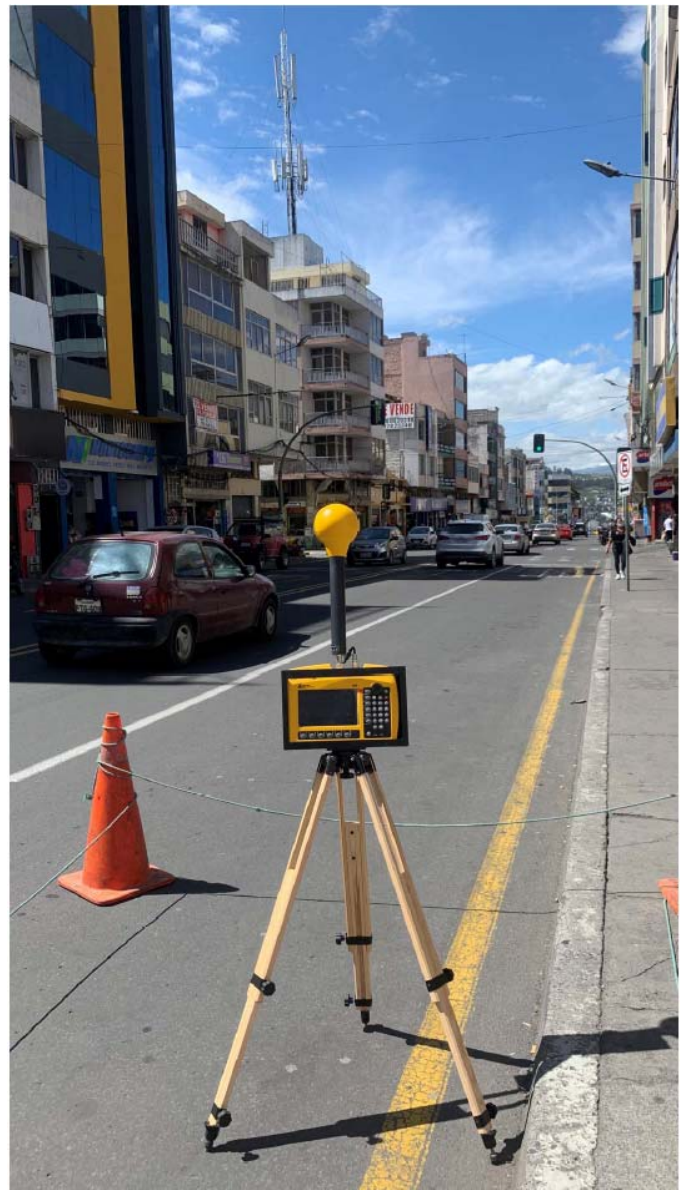
Fig. 8. Mediciones de Intensidad de campo eléctrico en P1 en el entorno de la estación base 5
