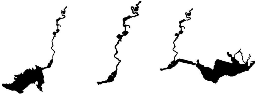
Figura 18. Resultado del procesamiento digital (desde la izquierda a la derecha) desde el Embalse Alacranes y el río Sagua la Grande en su estado natural (izquierda), la extracción del río desde el embalse (centro) y el desborde del río en el caso de un evento extremo de lluvias durante la tormenta tropical Alberto en el 2018 (derecha).
