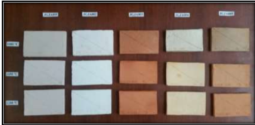
Foto 23: Color de las Placas JGJA 001 – JGJA 005 a temperaturas de 1000°C, 1050 °C y 1200 °C.
