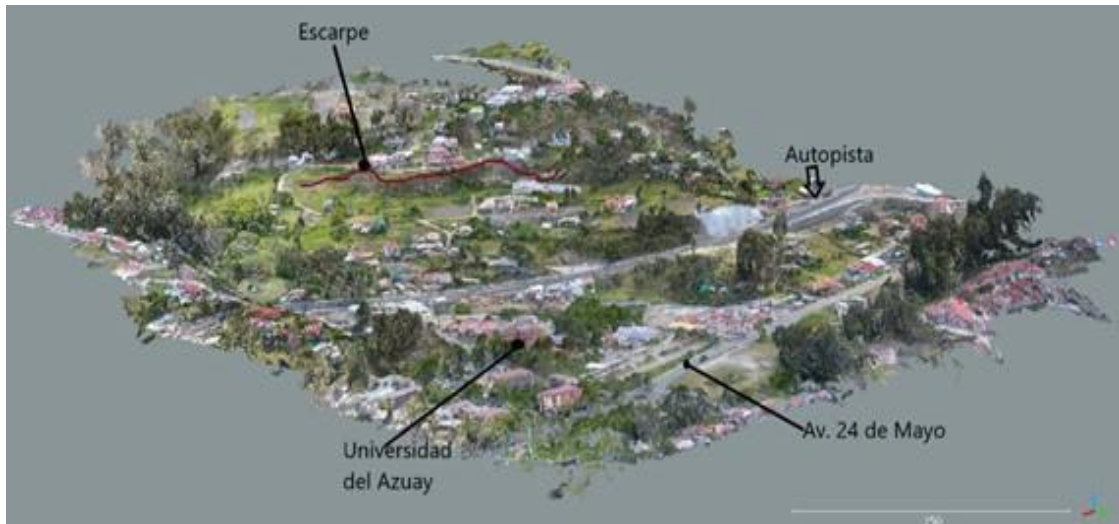
Figura 13. Nube de puntos del deslizamiento UDA obtenida mediante fotogrametría drone.
