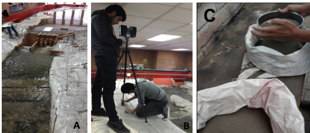
Figura 3. A y B: Modelo físico a escala 1:60 del proyecto hidroeléctrico Normandía. Laboratorio de Hidrofísica de suelos del PROMAS, Universidad de Cuenca. B: Escáner láser FARO 3D X130. C: Preparación del sedimento para el azolvamiento.
