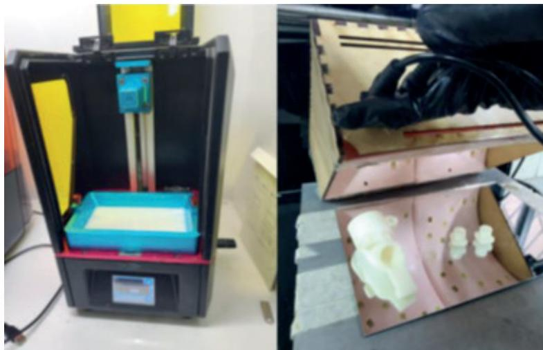
*Nota.* Impresora AnyCubic de resina utilizada para imprimir el codo de alimentación
