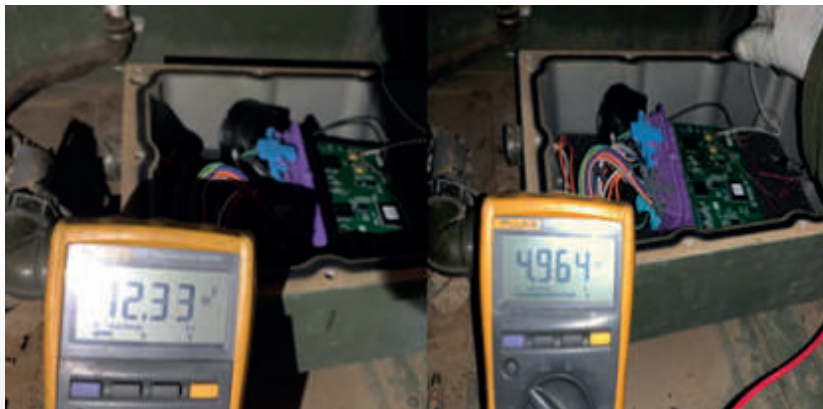
Figura 6: Verificación de funcionamiento tarjeta reparada
