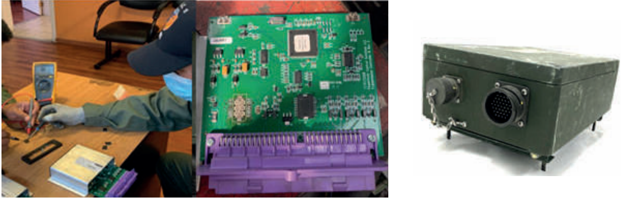
Figura 4: Verificación de elementos que fallan en tarjeta electrónica.
