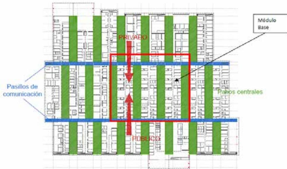
Figura 10. Módulo base para la construcción (Makiber, 2012)
