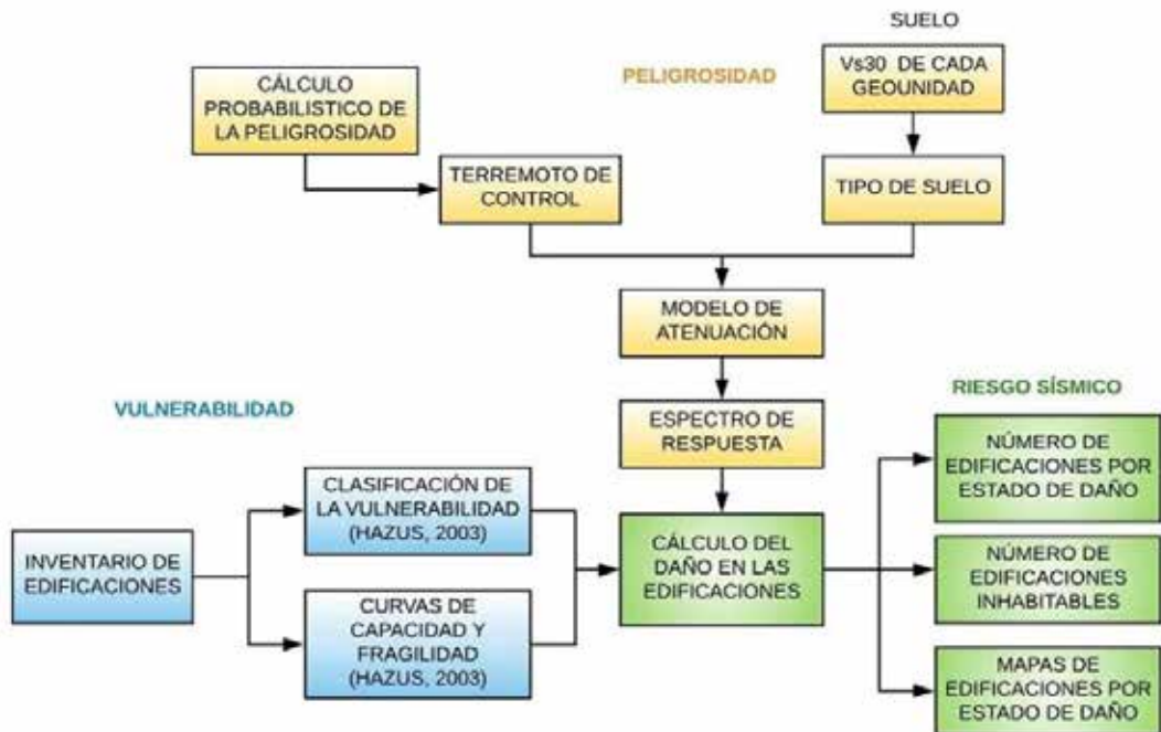
Figura 11. Esquema de Fases para el cálculo del Riesgo Sísmico. (Modificado de Parra, 2016)
