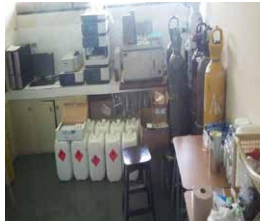
Figura 47 a - d: Almacenamiento inadecuado de los cilindros de GLP y b) Alto riesgo de producirse un conato de incendio.
