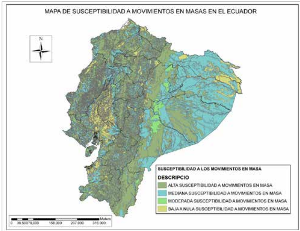
Fig. 12. Mapa de susceptibilidad a los movimientos en masa en el Ecuador. En base de Demoraes y D'ercole, (2001).
