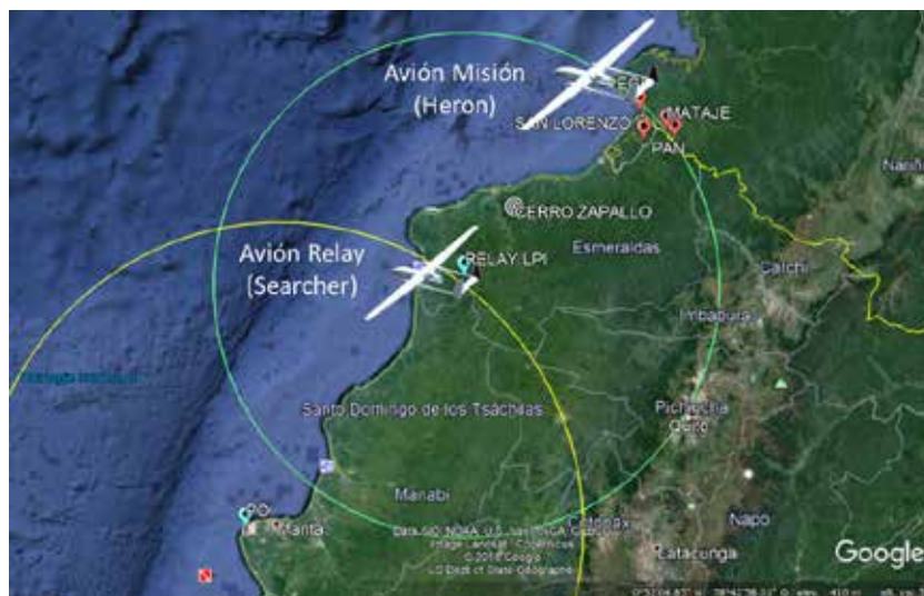
Figura 8. Empleo del UAV SEARCHER y UAV HERON en modo relay. Fuente ESCUAV.
