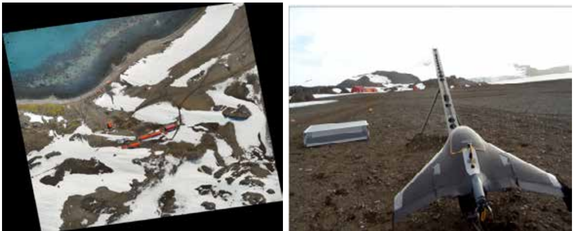
Figura 1. Levantamiento Orto-fotográfico en la Antártida con el UAV Trimble UX5. Fuente IGM.
