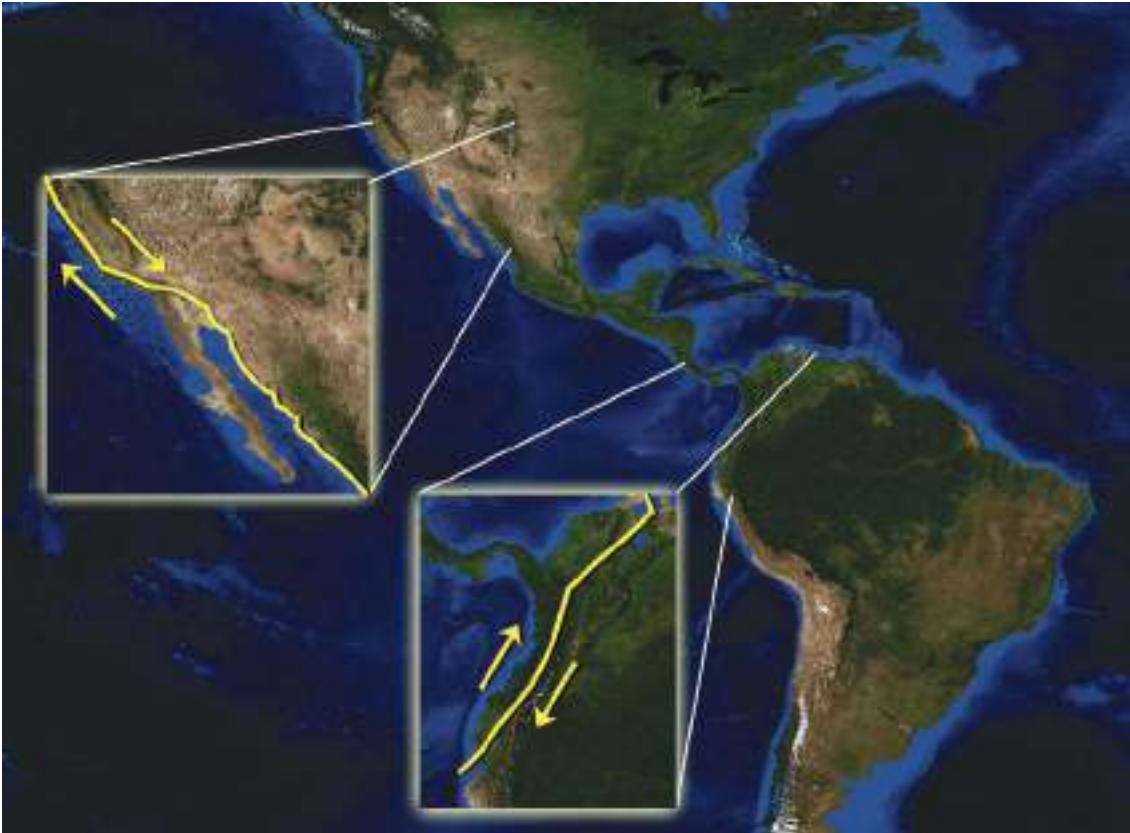
Figura 1: Sobrevisión sobre dos fallas geológicas emblemáticas en las Américas: izquierda arriba la falla San Andres en EEUU; abajo la Mega-falla Guayaquil-Caracas. Ambas fallas son de tipo trascurrente. La ciudad de Quito está ubicada encima de la Mega-falla. Toulkeridis, 2011
