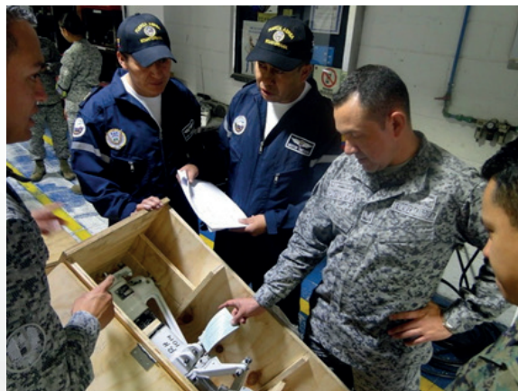
Figura 3: Mantenimiento de base nivel 3, overhaul trenes de aterrizaje aeronave A-29B de la Fuerza Aérea Colombiana
