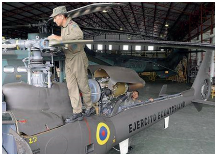
Figura 4: Mantenimiento de base, aeronave SA342L Gazelle de la Aviación del Ejército del Ecuador
