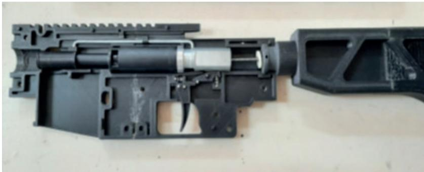
*Nota.* Cuerpo del arma no-letal con los elementos de propulsión, tubo de potencia, fiador, gatillo disparador, tubo, cañón y culata.
