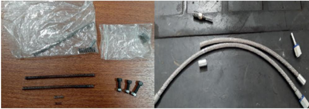
*Nota.* Manguera trenzada por donde ingresa el aire comprimido y elementos de sujeción
