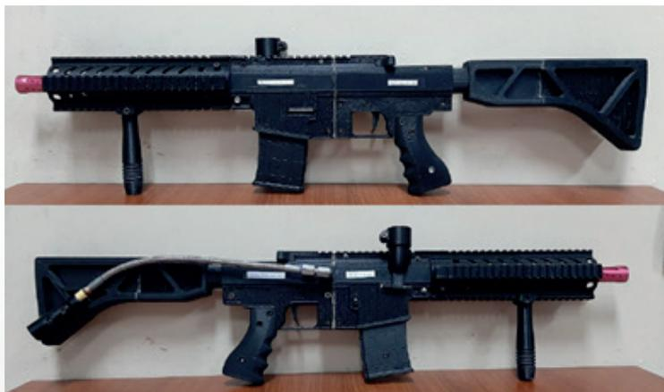
*Nota.* Vista frontal y posterior del arma no-letal impresa con manufactura aditiva.
