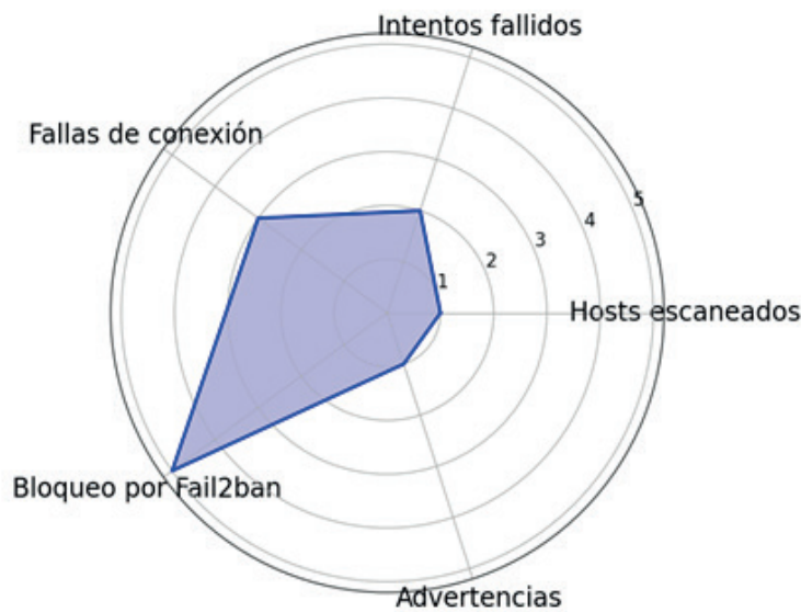
Figura 11: Efectividad de la herramienta fail2ban en los ataques de fuerza bruta
