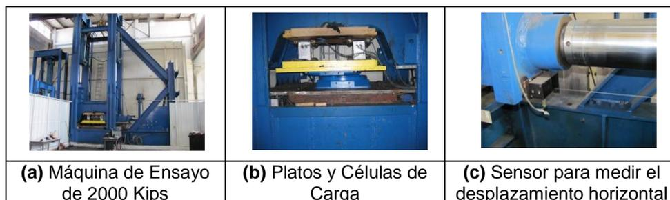
**Figura 13** Máquina de Ensayo de Aisladores Sísmicos tipo TPF
