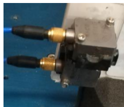
Figura 5 Acelerómetros usados en la investigación. Eje Y (superior) y eje X (inferior).
