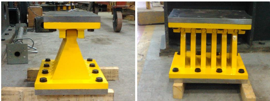
Figura 13 Disipadores TADAS de 6 placas a usar en el reforzamiento del Parqueadero de la ULEAM.
