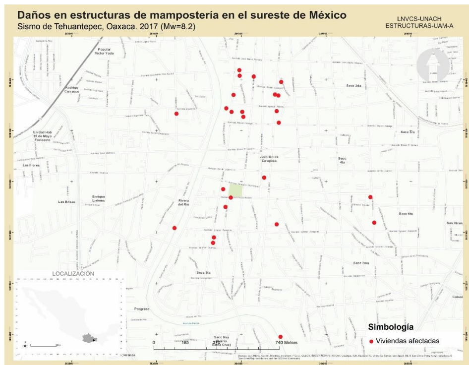
Figura 26 Localización geográfica del daño severo en viviendas y edificios de departamentos en la ciudad de Juchitán, Oaxaca.
