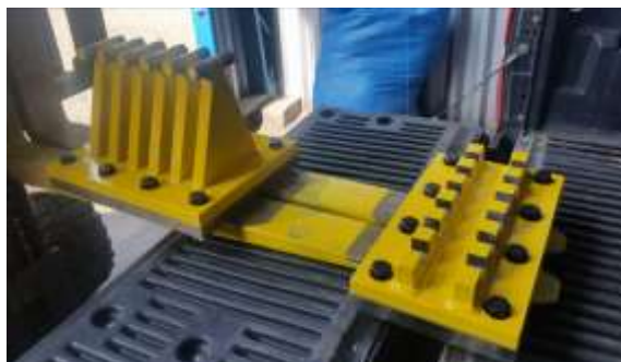
Figura 4 A la izquierda se observa la placa de flexión y a la derecha la placa de corte, también conocida como cremallera o peineta. SPD (2017).
