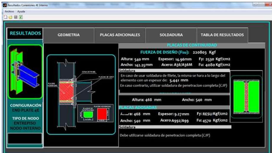
Figura 21. Pestaña Placas adicionales Ejemplo 1. Fuente: Los Autores
