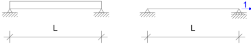
Figura 4 Modelo de un elemento articulado – articulado
