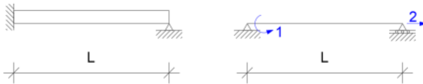
Figura 3 Modelo de un elemento empotrado - articulado
