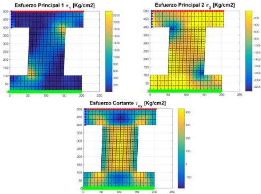
Figura 14 Esfuerzos principales y de cortante para una relación  $L/h = 3.0$ .
