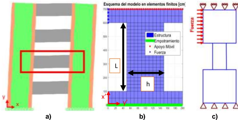
**Figura 3** Muros acoplados; a) Esquema general de muros; b) Modelo simplificado; c) Aplicación de cargas en el modelo
