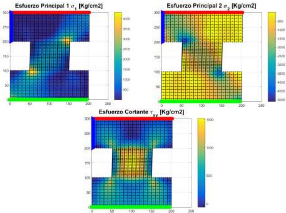
Figura 11 Esfuerzos principales y de cortante para una relación  $L/h = 1.0$ .
