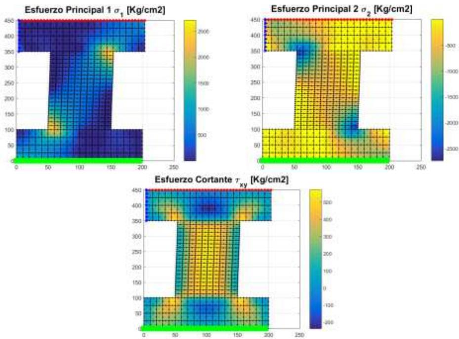
Figura 13 Esfuerzos principales y de cortante para una relación  $L/h = 2.5$ .
