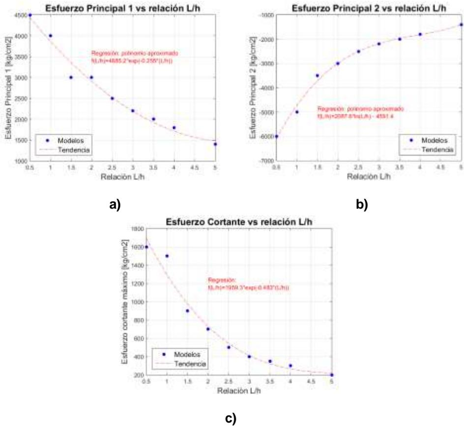
**Figura 10** Esfuerzos en vigas de acople para diferentes relaciones L/h; a) Esfuerzo principal 1; b) Esfuerzo principal 2; c) Esfuerzo de corte.
