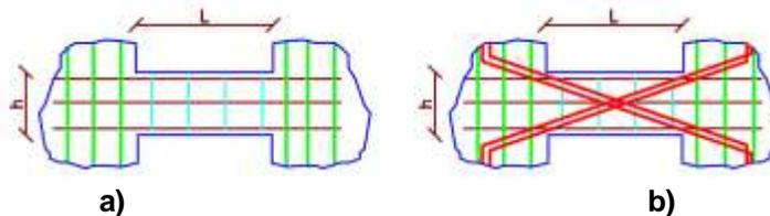
**Figura 1** Armadura de vigas de acople; a) Convencional; b) Diagonal
