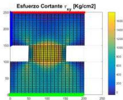
Figura 6 Esfuerzos principales y de cortante para una relación  $L/h = 0.5$ .
