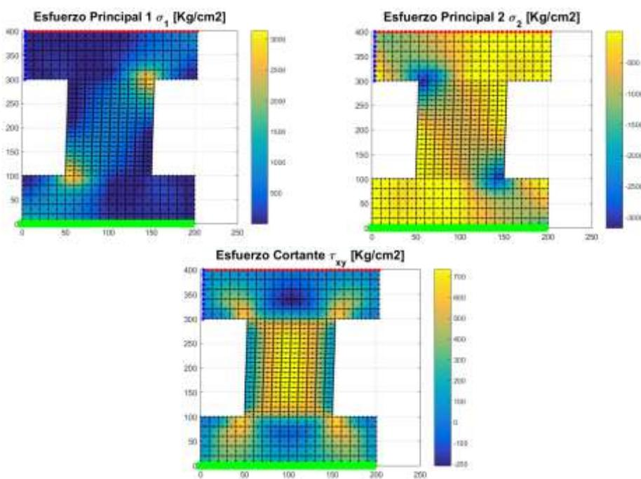
Figura 7 Esfuerzos principales y de cortante para una relación  $L/h = 2.0$ .
