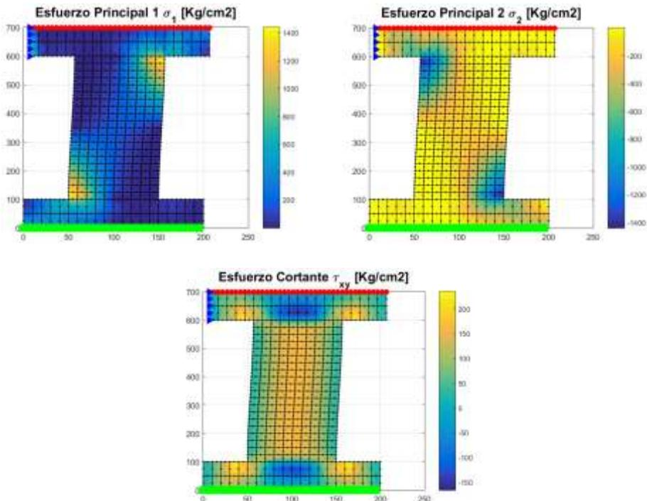
Figura 9 Esfuerzos principales y de cortante para una relación  $L/h = 5.0$ .
