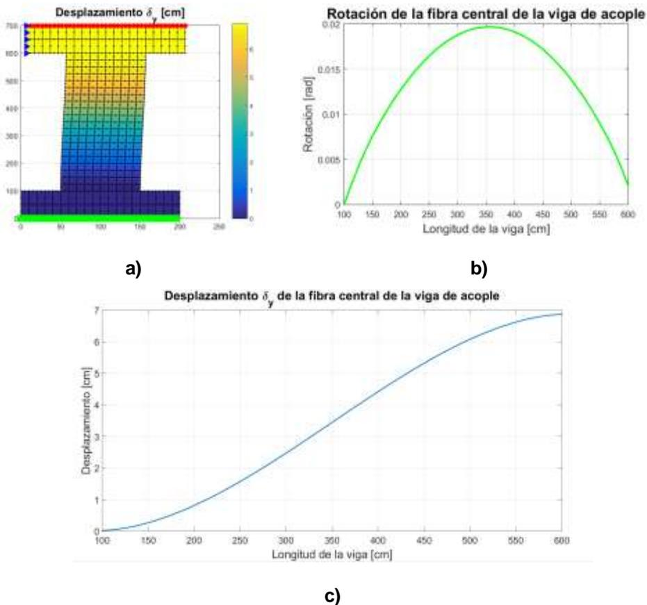
**Figura 4** Proceso para determinar el mecanismo de falla de las vigas (Modelo L/h = 5.0); a) Respuesta de desplazamientos del modelo de elementos finitos; b) Rotaciones en el eje central; c) Desplazamientos en el eje central.
