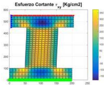
Figura 8 Esfuerzos principales y de cortante para una relación  $L/h = 3.5$ .
