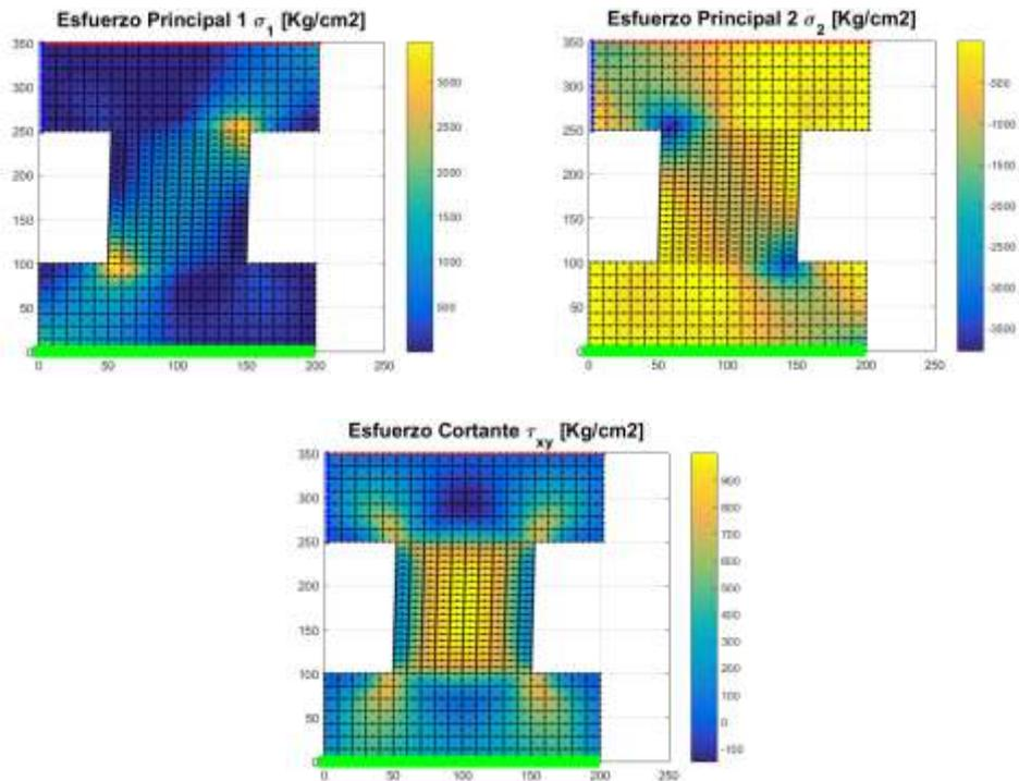
Figura 12 Esfuerzos principales y de cortante para una relación  $L/h = 1.5$ .
