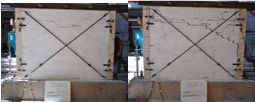
Figura 12 Respuesta cíclica del muro de mampostería confinada, MC
