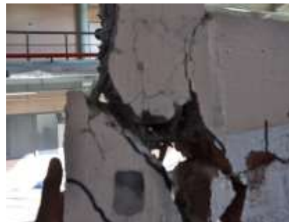
Figura 13 Patrón de agrietamiento en diferentes estados de carga del muro MC: a) ADP; b) SPI; c) CC; d) Estado final del muro.
