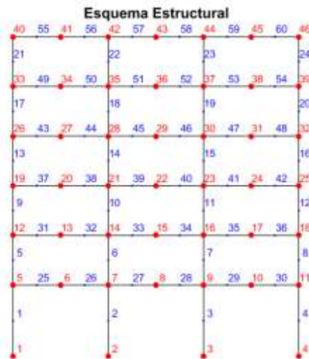
Figura 11 a) Código para dibujar las estructuras; b) Identificación de nudos y elementos; c) Grados de libertad para el análisis en CEINCI-LAB .
