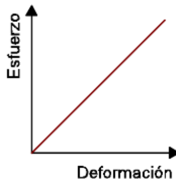
Figura 14 Modelo de elementos elástico (comportamiento lineal).
