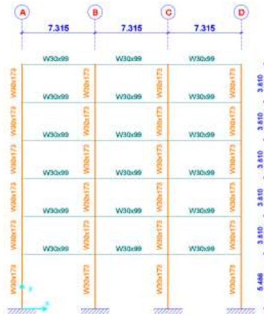
Figura 4 Geometría de la estructura de acero de 6 pisos e identificación de las secciones.
