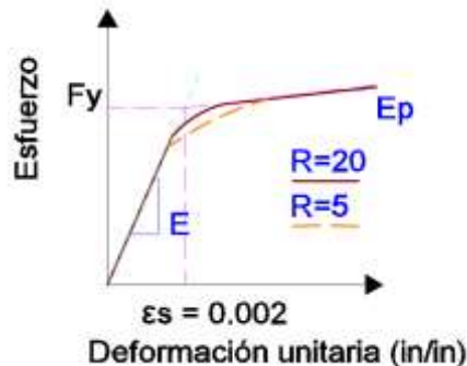
Figura 46 Modelo para las articulaciones en las diagonales de acero.
