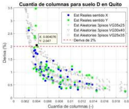
**Figura 26** Derivas vs Cuantía de columnas.
