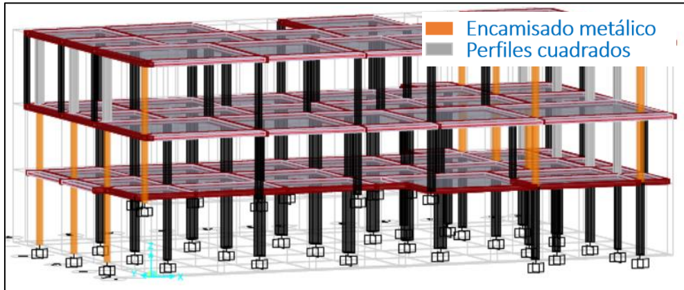
Figura 19 Propuesta reforzamiento estructura W.C.
