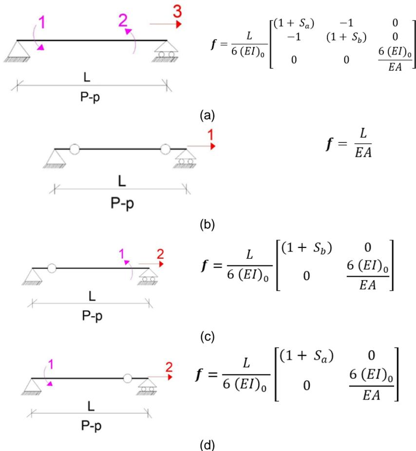
**Figura 28** Casos que se consideran para el cálculo de la matriz de rigidez de un elemento; a) Elementos con conexiones rígidas. b) Elementos únicamente con comportamiento axial; c) La conexión del lado izquierdo permite rotación; d) La conexión del lado derecho permite rotación; Para los cuatro casos se presenta la matriz de flexibilidad en sistema fundamental.
