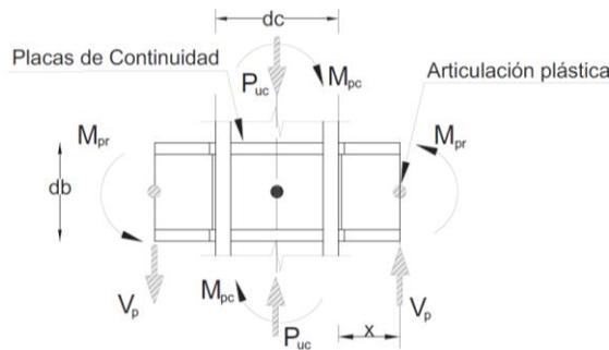
**Figura 22** Nudo de una columna interior de un pórtico. NEC-SE-AC 2015.
