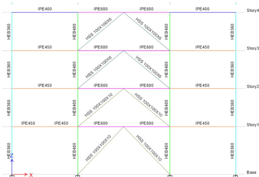
**Figura 23** Secciones del pórtico con base en un prediseño.
