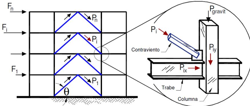
**Figura 9** Demandas por carga axial de la riostra en la conexión. Tomado de: Tapia y Martínez (2017).
