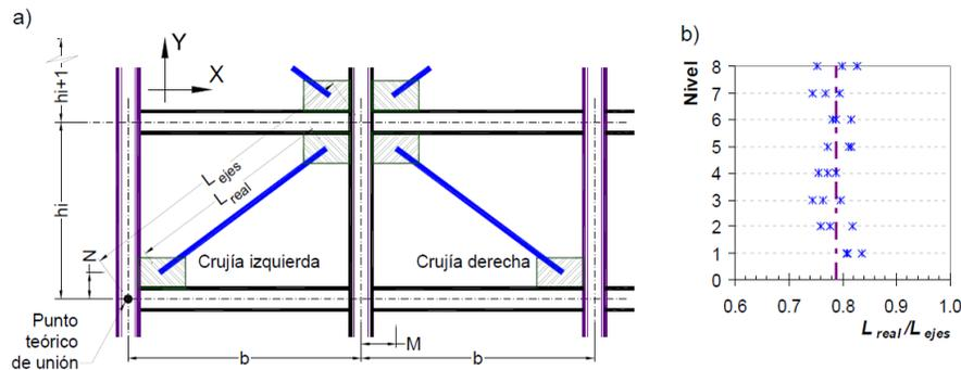
**Figura 10.** a) Longitud efectiva del contraviento, b) Proporciones obtenidas en Lacerte y Tremblay (2006) y Izvernari *et al* (2007) en modelos de ocho niveles. Tomado de: Tapia y Colunga (2013)
