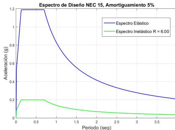
**Figura 12** Espectro de diseño para Quito – Suelo D.
