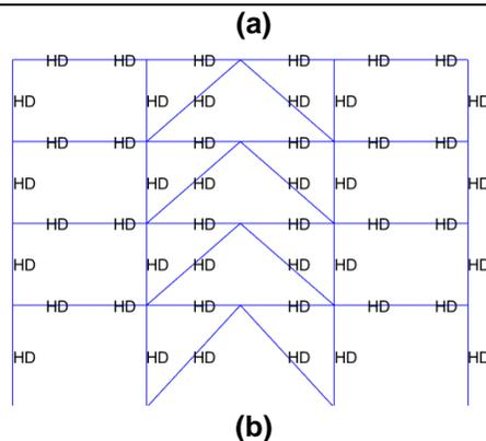
**Figura 42** a) Código de CEINCI-LAB; b) Clasificación de las secciones en el pórtico.
