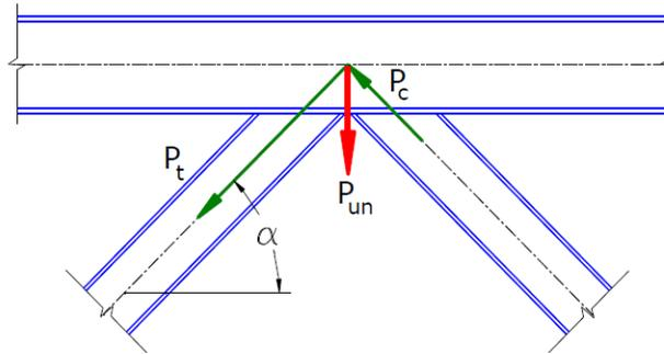
**Figura 7** Fuerza  $P_{un}$  resultante del desbalance de fuerzas en el nudo debido a las fuerzas de tracción y compresión. Fuente: Crisafulli (2014).
