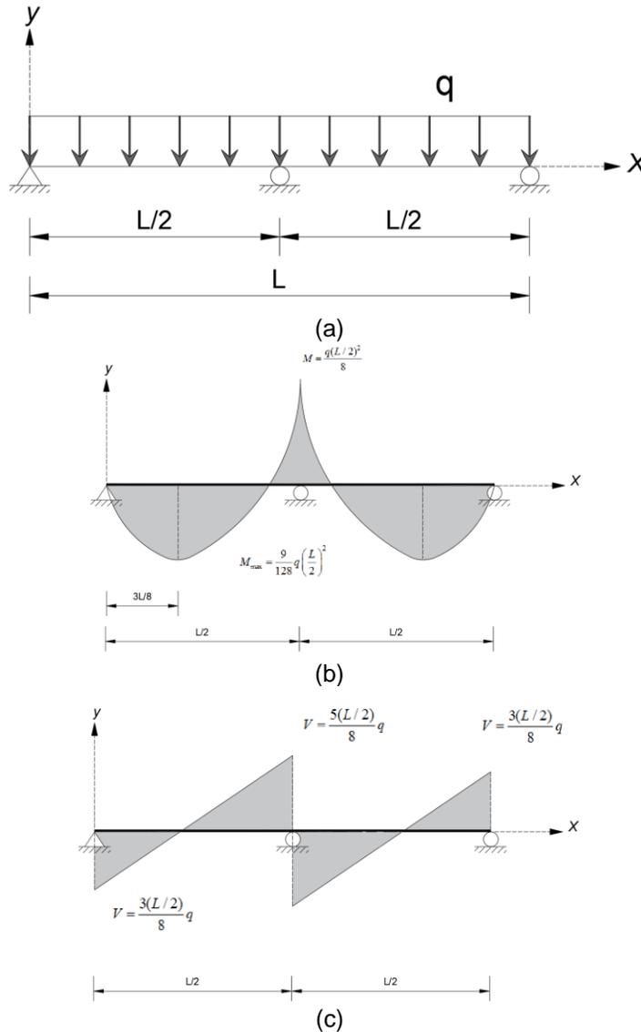
**Figura 15** a) Modelo simplificado para viga en la que convergen los arriostramientos; b) Diagrama de corte; c) Diagrama de momento.
