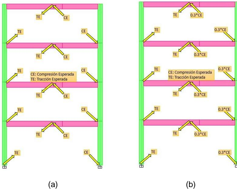
**Figura 6** a) Aplicación de máximas fuerzas esperadas debido a la capacidad de las diagonales (caso i); b) Aplicación de fuerza esperada a tracción y fuerza esperada a compresión posterior al pandeo (caso ii).
