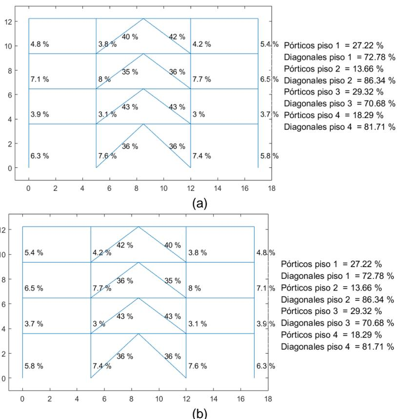
**Figura 49** Porcentaje de cortante resistido por columnas y diagonales: a) Sismo de izquierda a derecha; b) Sismo de derecha a izquierda
