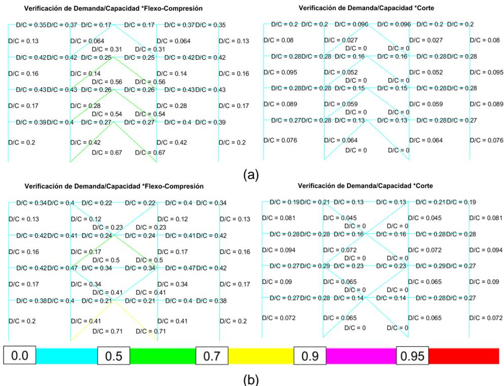
**Figura 63** a) Demanda vs Capacidad a Flexo-Compresión y corte en V invertida; b) Flexo-Compresión y corte en X de múltiples pisos.
