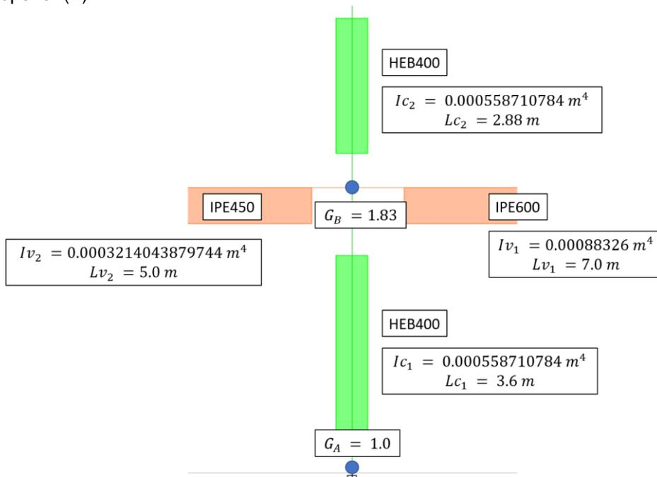
**Figura 44** Detalle de valores involucrados en el cálculo de K para la columna de planta baja en el eje B.
