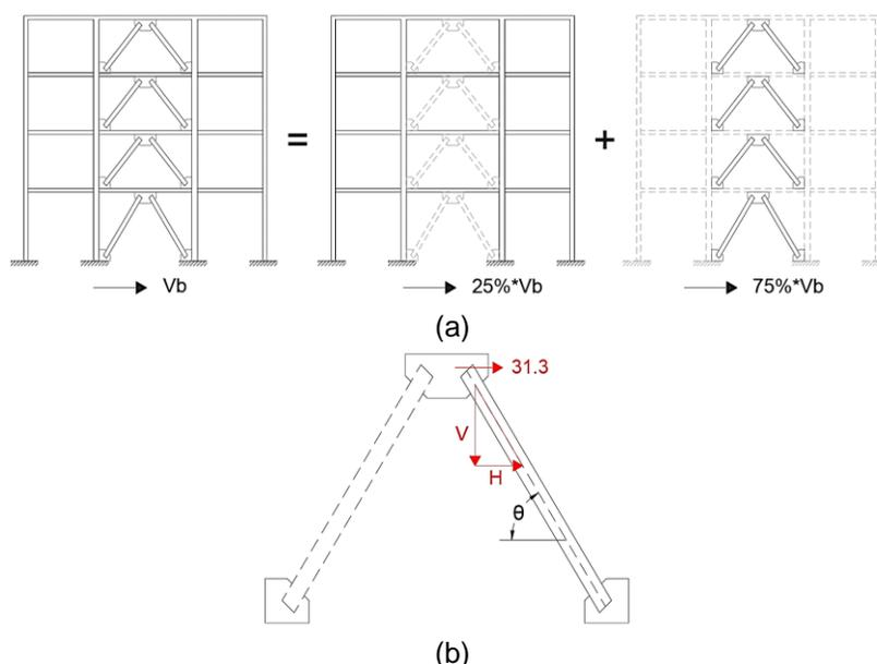
**Figura 17** a) Fuerzas laterales y elementos que resisten esa acción; b) Riostras del primer nivel y componentes Horizontal y Vertical de la riostra en compresión.
