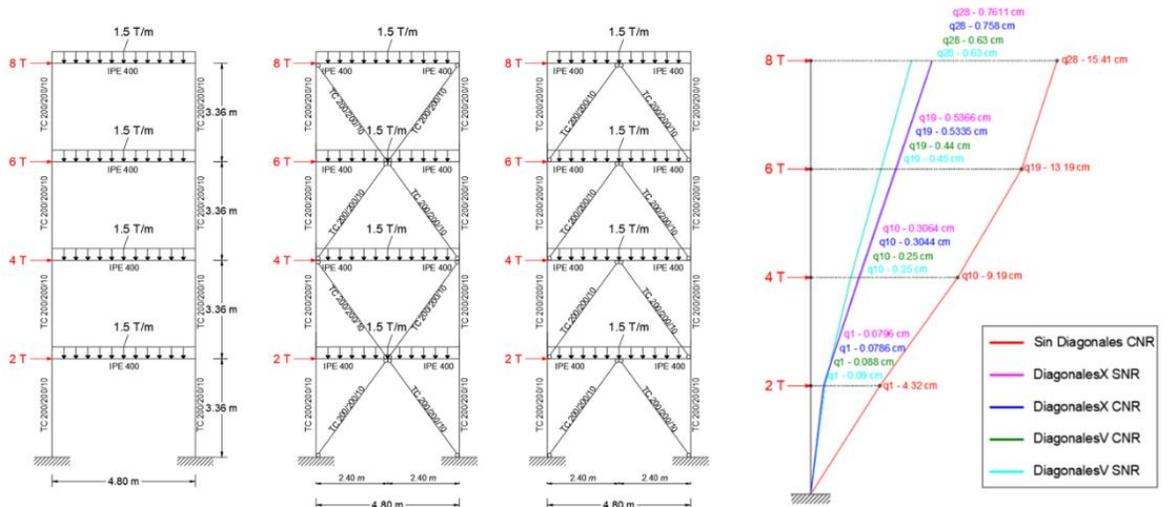
**Figura 2** Diferentes tipologías estructurales de estructura de acero y respuesta en desplazamientos. Aguiar (2020).
