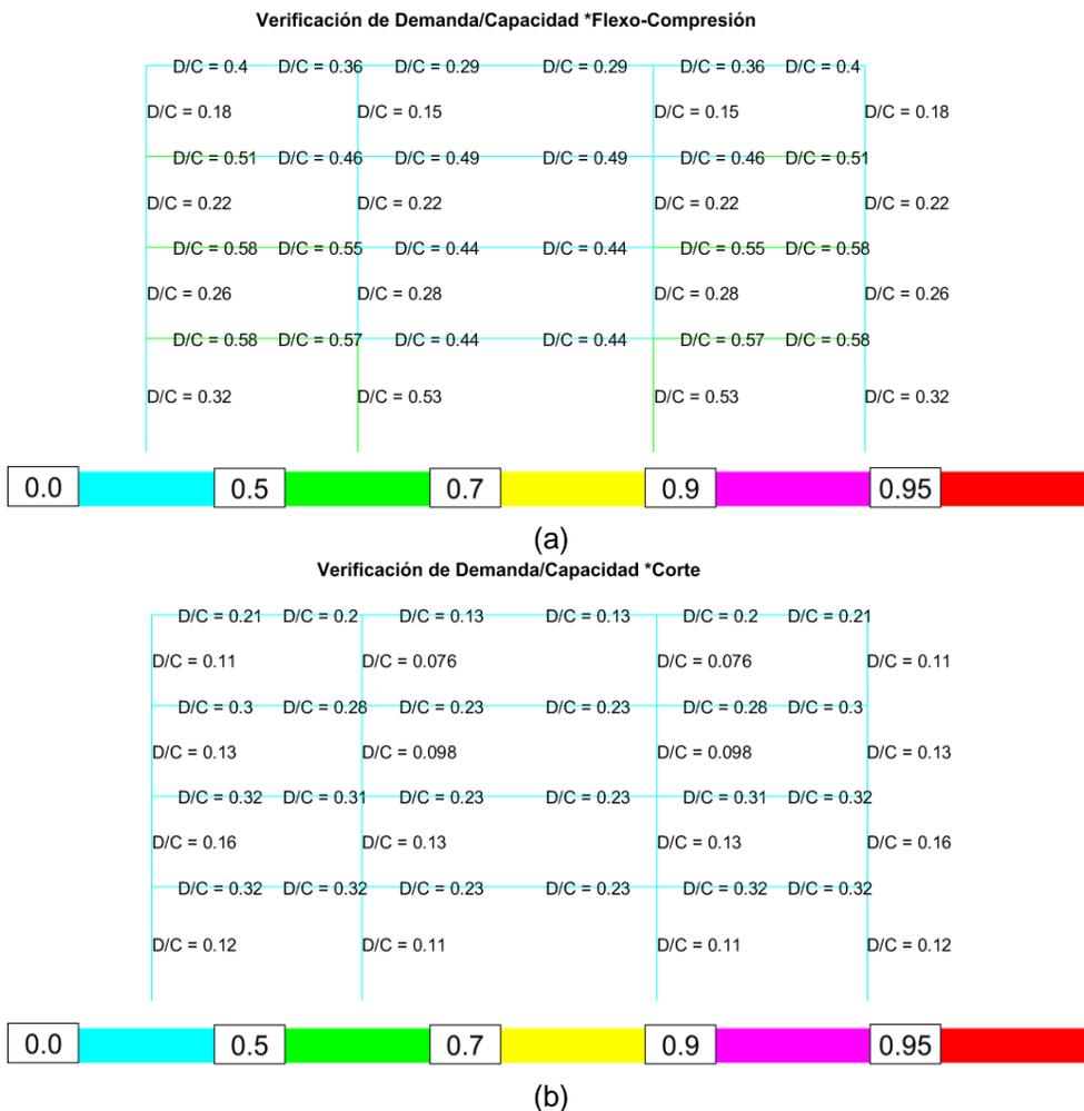
**Figura 55** a) Demanda vs Capacidad a Flexo-Compresión; b) Demanda vs Capacidad a Corte
