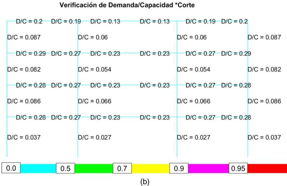
**Figura 51** a) Demanda vs Capacidad a Flexo-Compresión; b) Demanda vs Capacidad a Corte
