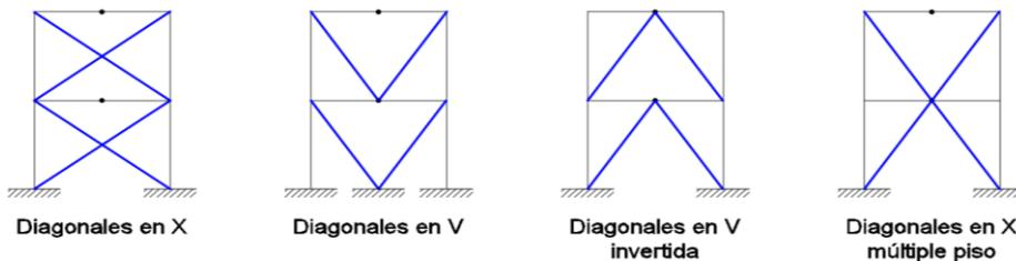
**Figura 5** Pórticos con diagonales concéntricas
