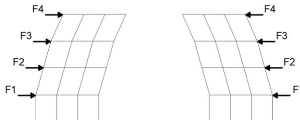
**Figura 36** Cargas laterales aplicadas a las estructuras.
