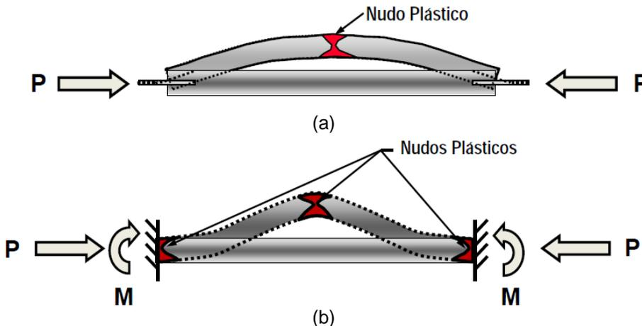
**Figura 26** a) Comportamiento de riostra sometida a compresión; b) Comportamiento de riostra sometida a compresión y flexión.
