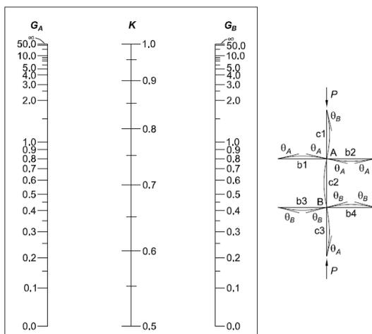
**Figura 43** Nomograma para determinar los Factores K en marcos arriostrados que restringen el desplazamiento lateral. Tomado de: AISC 360 – 10. Alacero.
