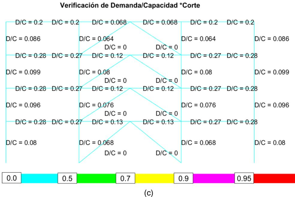
**Figura 47** a) Demanda vs Capacidad axial; b) Demanda vs Capacidad a Flexo-Compresión; c) Demanda vs Capacidad a Corte
