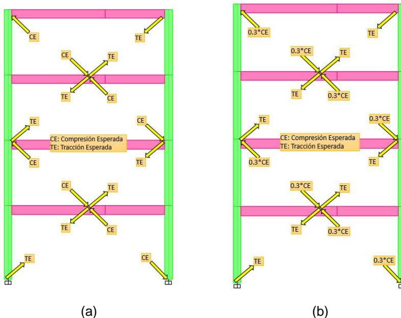
**Figura 8** a) Aplicación de máximas fuerzas esperadas debido a la capacidad de las diagonales (caso i); b) Aplicación de fuerza esperada a tracción y fuerza esperada a compresión posterior al pandeo (caso ii).
