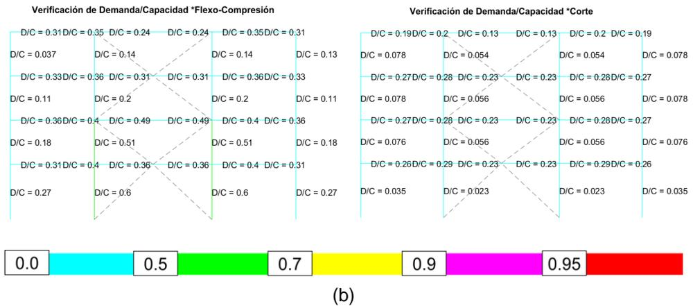
**Figura 64** a) Demanda vs Capacidad a Flexo-Compresión y corte en V invertida; b) Flexo-Compresión y corte en X de múltiples pisos.
