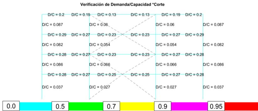
**Figura 62** a) Demanda vs Capacidad a Flexo-Compresión caso i; b) Demanda vs Capacidad a Corte caso i; c) Demanda vs Capacidad a Flexo-Compresión caso ii; d) Demanda vs Capacidad a Corte caso ii.
