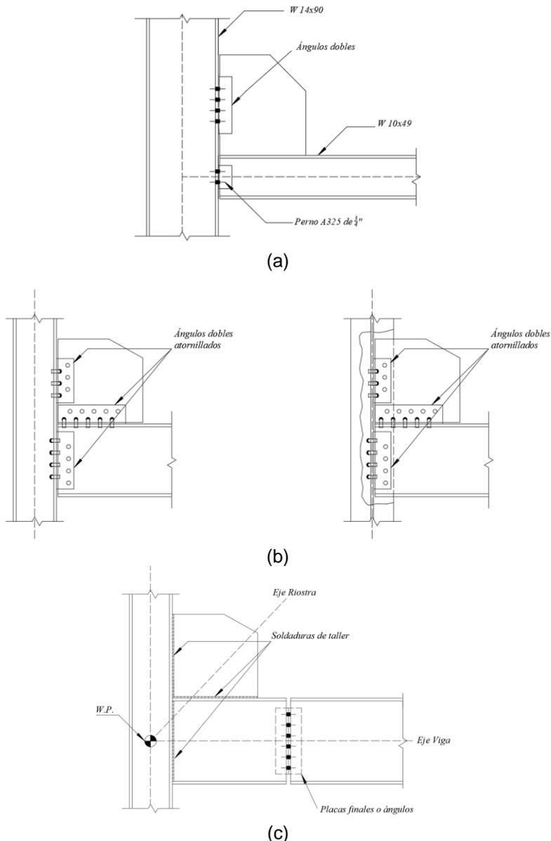
**Figura 14** Conexiones viga-columna que permiten la rotación a) Stoakes y Fahnestock (2010); b) McManus et al. (2013); c) Thornton y Muir (2008).
