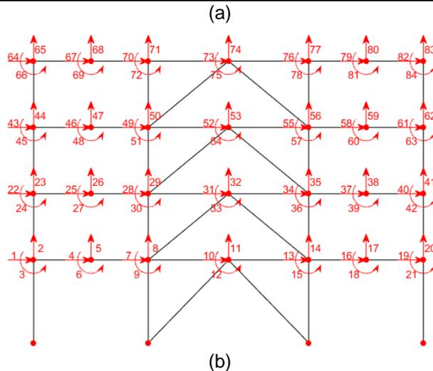
**Figura 35** a) Código de CEINCI-LAB; b) Grados de libertad para el análisis estático.
