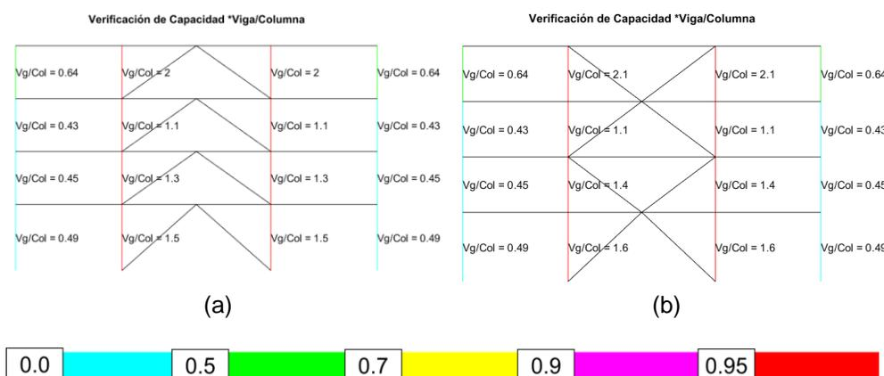
**Figura 66** Relación de la capacidad de las vigas/columnas: a) Configuración V invertida; b) Configuración en X de múltiples pisos.
