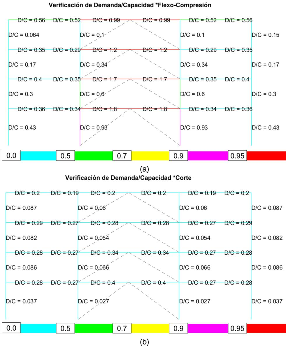
**Figura 57** a) Demanda vs Capacidad a Flexo-Compresión; b) Demanda vs Capacidad a Corte
