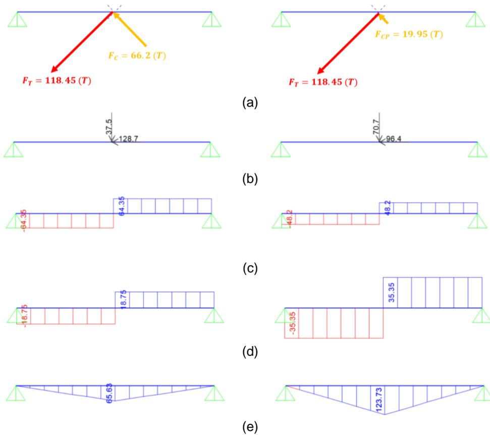
**Figura 19** a) Fuerzas esperadas a tracción y compresión en las diagonales (caso i al lado izquierdo y caso ii a lado derecho); b) Resultantes de las componentes horizontal y vertical; c) Diagrama axial; d) Diagrama de Corte; e) Diagrama de momento.
