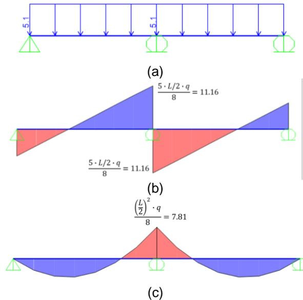
**Figura 16** a) Modelo simplificado para viga en la que convergen los arriostramientos; b) Diagrama de corte; c) Diagrama de momento.
