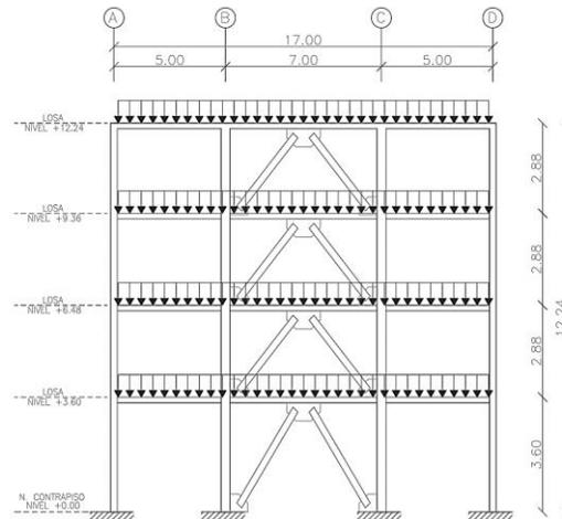
**Figura 11** Geometría del pórtico analizado
