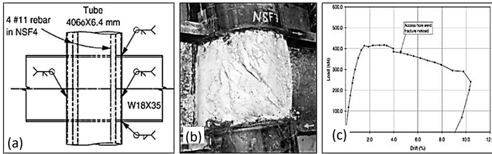
Figura 7 Nudo híbrido entre columna y viga. (a) Detalle de espécimen. (b) Fallo de cortante (c) Curva carga – deriva. (Elremaily & Azizinamini 2001).
