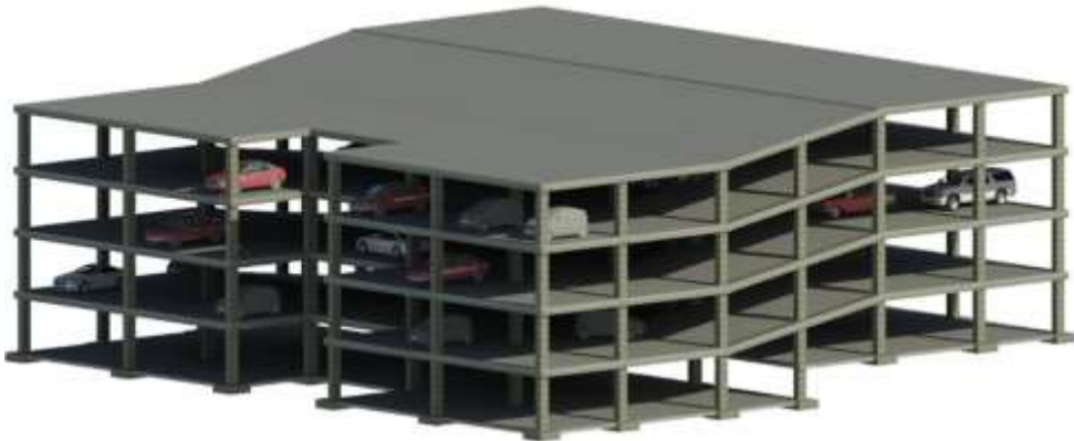
Figura 6 Vista espacial de la estructura del ex parqueadero de la ULEAM, antes de ser reforzado. En la abertura se tenía una grada.
