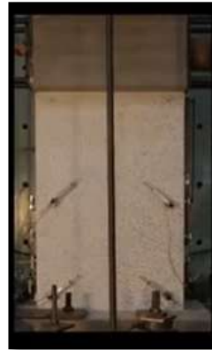
Figura 5. Muro RW6 sin reparación listo para ensayarse.
