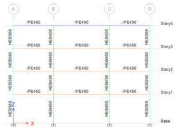
Figura 2. Secciones del pórtico con base en un prediseño.
