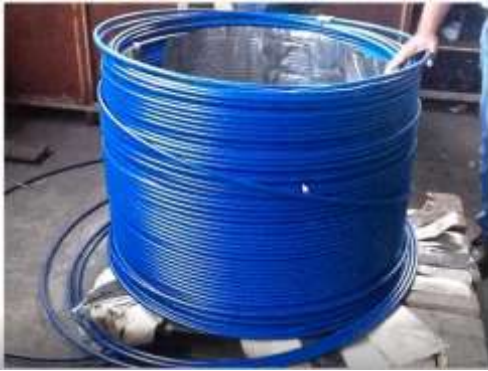
Figura 1. Cable postensado recubierto con plástico de alta densidad.
