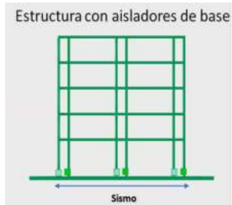
Figura 6. Estructura con Aisladores de Base
