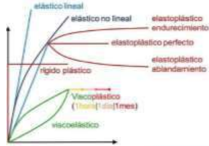
Figura 10. Comportamiento esfuerzo-deformación idealizado del suelo.
