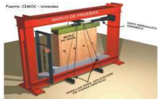
Figura 4. Marco de pruebas para el ensayo de cargas paralelas al plano.
