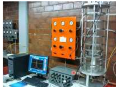
Figura 4. Equipo de ensayo de columna resonante.
